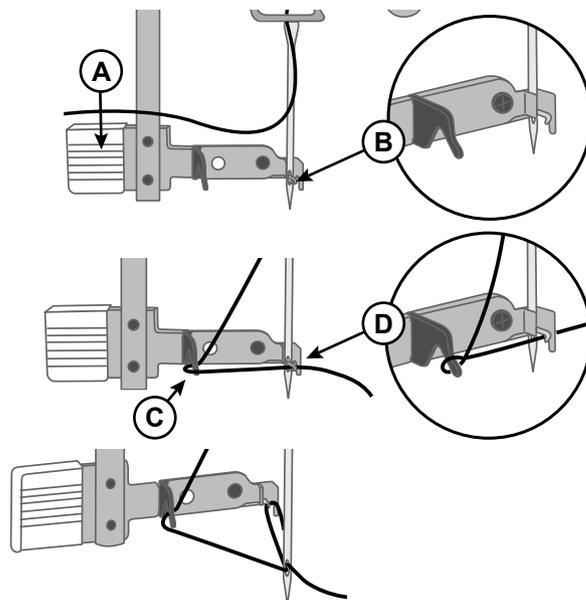
*Remarque: L'enfile-aiguille est conçu pour être utilisé avec des aiguilles de taille 70 110. Vous ne pouvez pas utiliser l'enfile-aiguille pour les aiguilles de taille 60 ou moins, ni avec les aiguilles lancéolées ou doubles. Certains accessoires en option exigent un enfilage manuel de l'aiguille. Lorsque vous enfiler l'aiguille manuellement, assurez-vous que l'aiguille est enfilée de l'avant vers l'arrière.*
